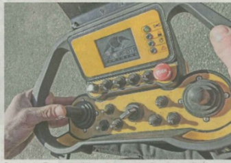
Damit beim Einsatz des Minenräumers keine Personen gefährdet werden, wird er aus der Distanz ferngesteuert. Foto: Enrique Muñoz Garcia
